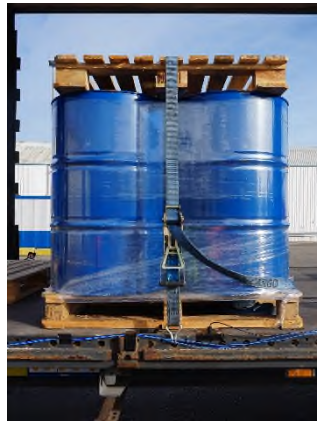
Variante 2 mit Paletten, maschinell gewickelt / Variant 2 with pallets, mechanically wrapped
