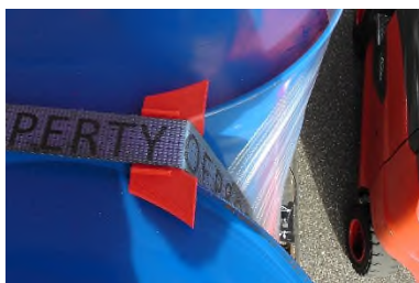
Sicherung der Fässer / Securing of drums
