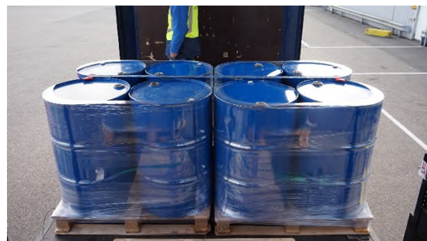
Variante 3 mit Drumclip / Variant 3 with drumclips
